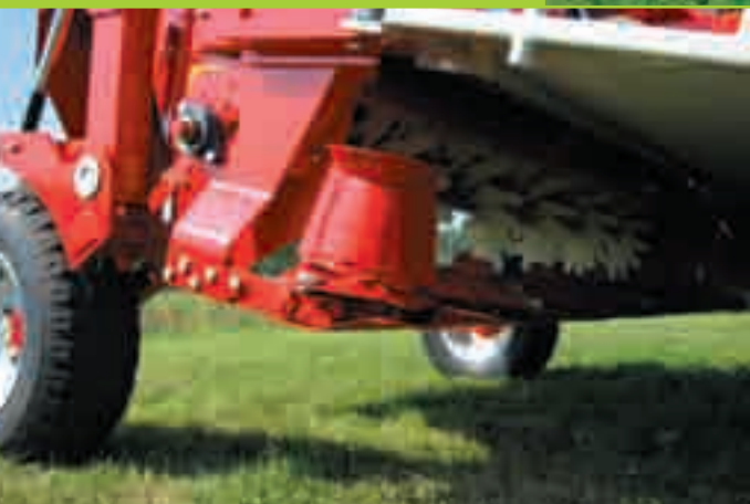
A hajtómű átfordításával egyszerűen válthatunk 540-ről 1000 f/perces fordulatszámra.
