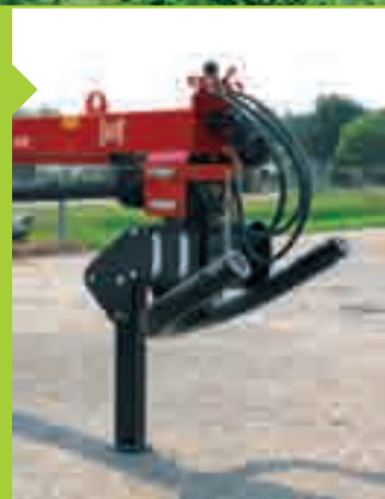
A hajtómű átfordításával egyszerűen válthatunk 540-ről 1000 f/perces fordulatszámra.
